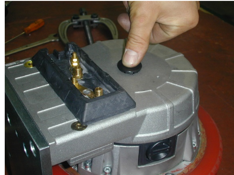
15. Verschlußstopfen in die Bohrung setzen
